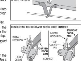
NSTALLING THE DOOR BRACKET (SECTIONAL DOOR)
